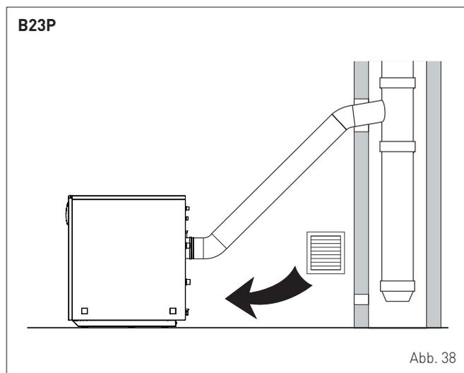
Das Rauchabzugsrohr ist für den Betrieb der Anlage von grundlegender Bedeutung. Wird es nicht gemäß den vorgegebenen Kriterien ausgeführt, kann es zu Störungen des Brennerbetriebs, starken Betriebsgeräuschen, Rußbildung, Kondensation und Verkrustungen kommen.
