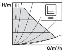
Wird für Systeme mit Fußbodenheizung oder großen Rohrleitungen sowie für alle Anwendungen empfohlen, die keine variablen Kennlinien aufweisen (wie zum Beispiel Speicherladepumpen), und Einrohr-Heizsysteme mit Heizkörpern. Die Regelung behält unabhängig von der geförderten Wassermenge die eingestellte Förderhöhe bei.
