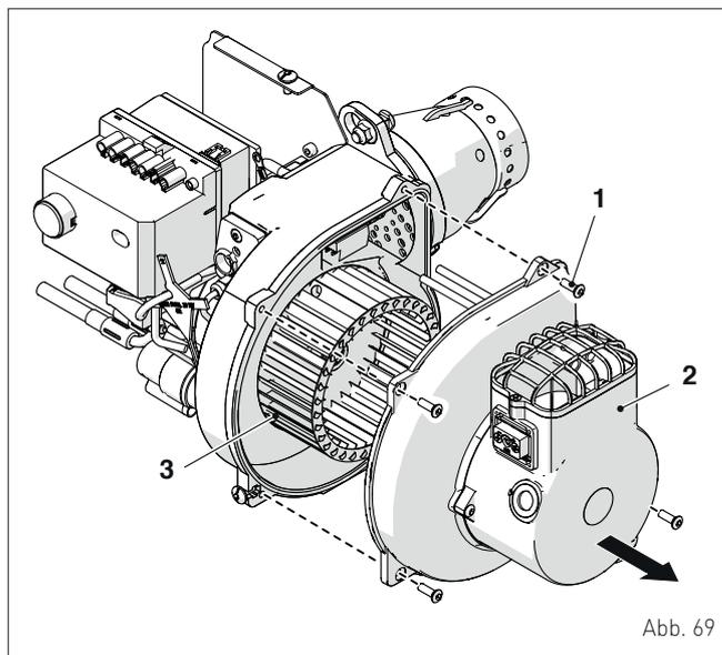
Bei Austausch des Motors und/oder des Gebläserads (3) ist zu beachten, dass der Abstand zwischen der unteren Drehebene (A) des Gebläserads etwa 1 mm zur Ebene (B) des Gehäuses beträgt, siehe Abbildung.
