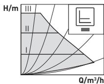
Συνιστάται σε περίπτωση θερμαντικών σωμάτων ακτινοβολίας ή σωληνώσεων μεγάλων διαστάσεων και για όλες τις εφαρμογές χωρίς μεταβλητές χαρακτηριστικές καμπύλες της εγκατάστασης, (όπως, για παράδειγμα, αντλίες φόρτωσης μπόιλερ) και για εγκαταστάσεις θέρμανσης μιας εξόδου με θερμαντικά σώματα. Η ρύθμιση διατηρεί το επιλεγμένο μανομετρικό ύψος ανεξάρτητα από την παροχή.
